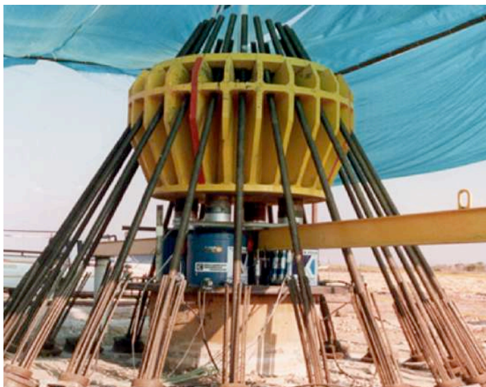
Prova di carico 2500 ton.
